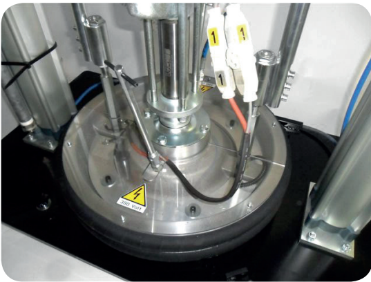
Piatto premante riscaldato con doppia guarnizione toroidale per fusto lt.200 a potenza maggiorata
