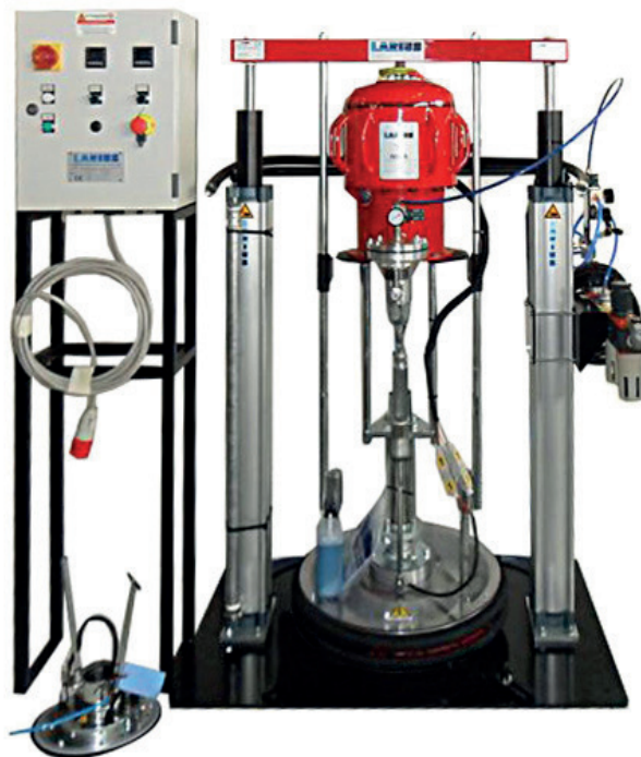
NOVA 55:1 su paranco doppia colonna con piatto riscaldato a doppia guarnizione fusto lt.200. Disponibile anche nella versione con piatto riscaldato per fusti lt.30
